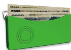
お財布型の紙幣判別機。紙幣を入れた状態でカメラスイッチを押すと音声・ブザー音・振動にて通知。電子マネーカードの残高も読み上げます。
